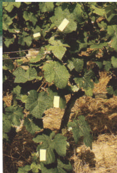
Fig. 213.3: Cartine idrosensibili posizionate a diverse altezze. Vanno messe anche sul retro delle foglie.
